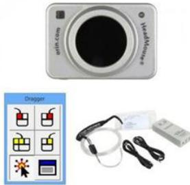
**제 품 개 요** 지체/뇌병변등의 장애로 인해 상지를 사용하기 어려운 경우 적외선을 이용하여 난반사타켓을 이마 등에 붙이고 머리를 움직여서 마우스커서를 이동하는 특수마우스입니다. 마우스 클릭 기능을 프로그램 이용방식과 호흡을 이용한 방식 두 가지 다 사용할 수 있습니다.
