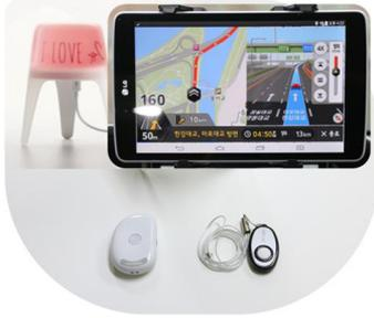
**제 품 개 요** 청각/언어 장애인이 운전 또는 도보로 이동할 때 네비게이션에서 방향 등 음성 메시지를 안내할 때 블루투스 진동알림기에서 진동과 조명으로 알려주어 목적지까지 안전하게 이동할 수 있도록 도와주며, 기상 알림, 카톡메시지 정보를 강력한 진동과 조명으로 알려줍니다. 또한 소리신호기는 조명 및 소리 감지 시 조명으로 안내하는 기기와 방문객 또는 가족이 무선리모컨을 눌러 호출할 경우 조명으로 알려주는 스마트한 정보통신 보조기기
