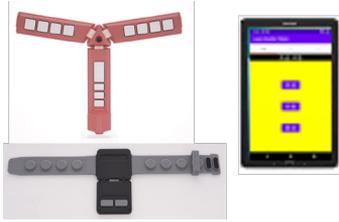
**제 품 개 요** 웨어러블 스마트 점자 키보드로 스마트기기에 블루투스 연결하여 스마트폰의 화면을 제어 할 수 있고 점자를 입력하면 문자로 전환되어 문서 작성 및 편집이 가능하고, 전화 걸기, ARS, 각종 채팅 어플등 각종 앱에 쉽게 접근하여 사용을 할 수 있다. / 모든 화면의 움직임과 입력 점자는 TTS 기능을 통해 소리로 확인 할 수 있다. 점자 학습 프로그램을 통해 점자를 단계별 학습 및 점자 입력 훈련을 할 수 있다. 2종의 키보드, 점자 훈련 프로그램 내장 테블릿으로 구성
